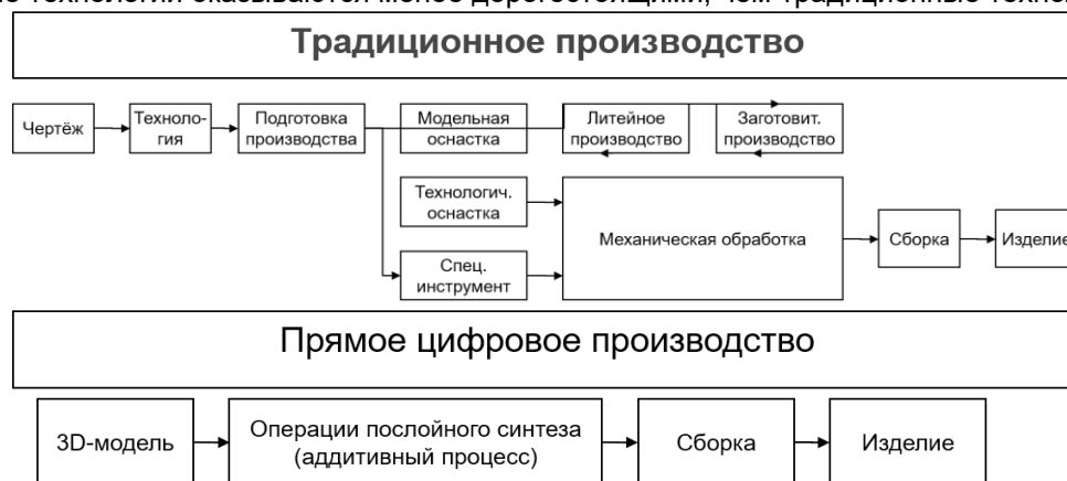
Рисунок 5 – Технологические циклы традиционного и цифрового производства
